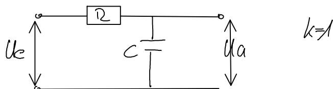
$$G(\omega) = \frac{1}{1 + i\omega \tilde{\zeta}} = \frac{1}{1 + i\omega RC} \quad \text{Deby-Funktion}$$
